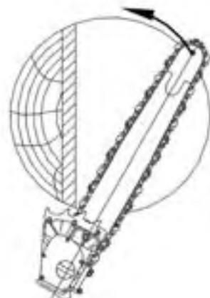
Рисунок 11 – Схема проведения основного пропила.
