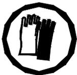
Для уменьшения воздействия вибрации при пилении всегда использовать рукавицы с вкладышами Мв62а8, или вкладыши виброизолирующие УВ 305 ОН.
