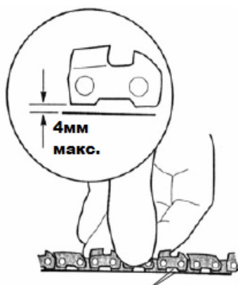
Проверьте расстояние между шиной и звеном цепи
