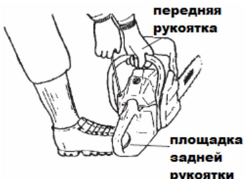
**Внимание !** Никогда не вытягивайте полностью стартерный шнур , чтобы избежать поломки стартерного механизма. Перед резким вытягиванием стартерного шнура, вытяните шнур на 10-15 см, чтобы собачки стартера вошли в сцепление с маховиком.
